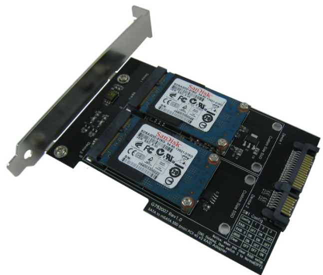
R2021B 組裝 mSATA 固態硬碟
