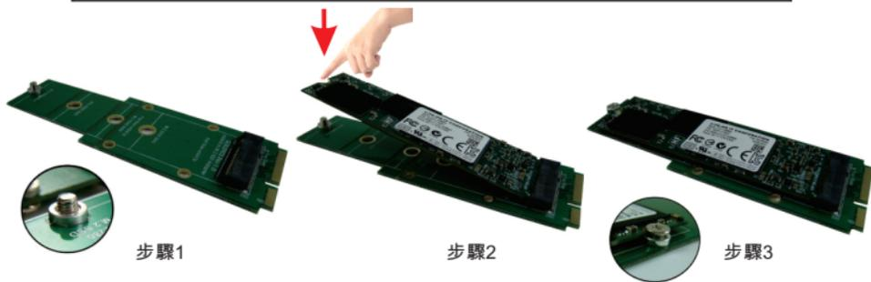
步驟 1:將合金銅柱放於轉接卡上適合您SSD的長度的固定孔,並使用M3x5螺絲由轉接卡底部往上鎖住轉接卡及銅柱(如圖一)
